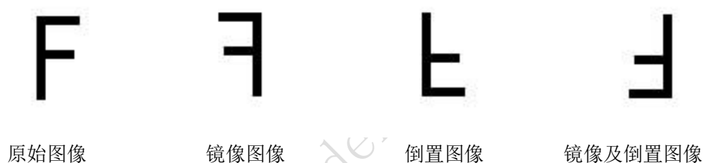
图 2-11 镜像和倒置实例
